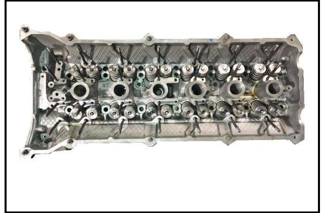
Tapa cilindros : vista lado escape
