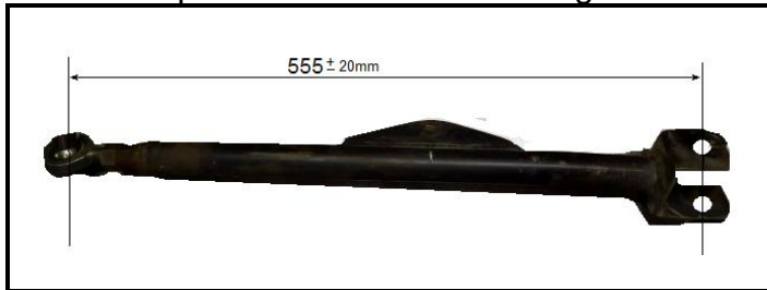
Parrilla suspension trasera de amortiguador
