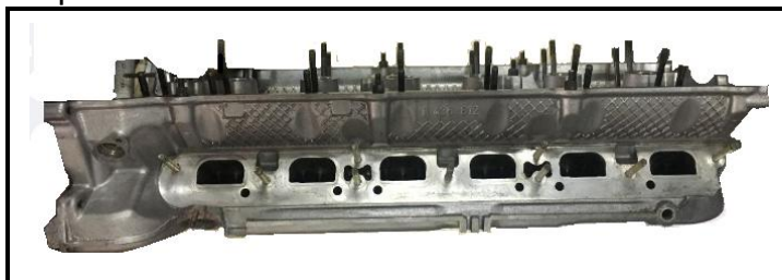
Tapa cilindros vista lado distribucion
