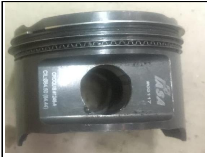
Piston alternativo vista lateral
