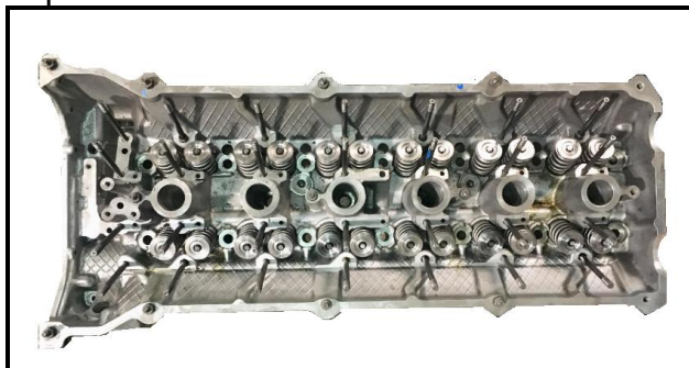
Tapa cilindros vista lado escape
