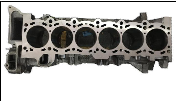
Block motor lado derecho :
