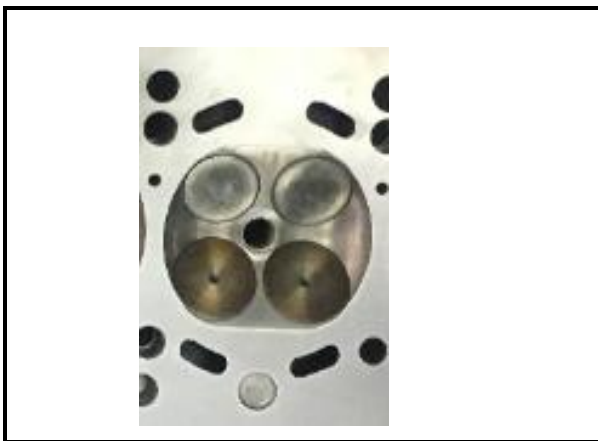
Tapa cilindro: vista cámara de combustión
