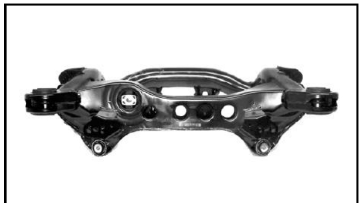
Sub chasis trasero visto de abajo:
