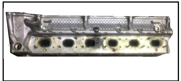
Tapa cilindros : visto lado volante
