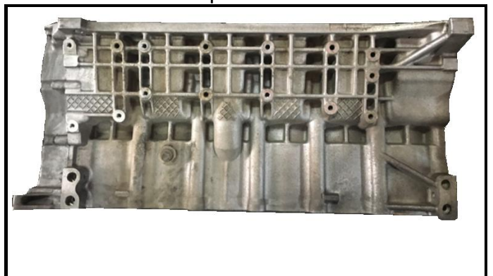
Block motor lado distribucion :
