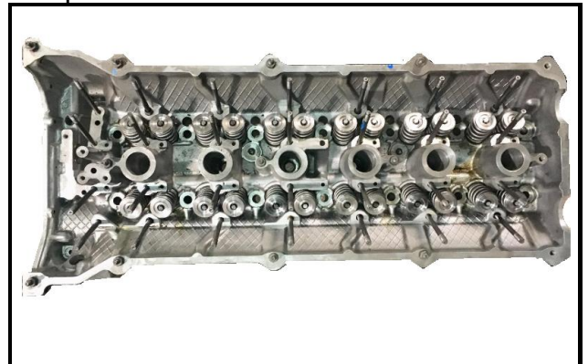
Tapa cilindros vista lado escape
