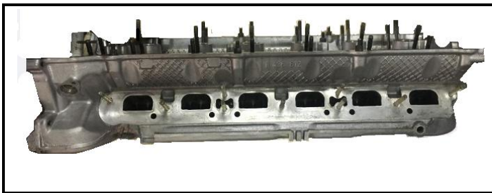
Tapa cilindros : vista lado distribucion
