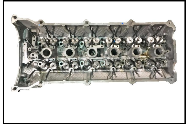
Tapa cilindros : vista lado escape
