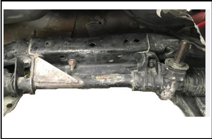
Refuerzo caja direccion
