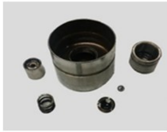
Botador y sus componentes 33 o 35 mm
