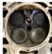
Cámara de combustión
