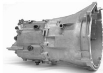
Caja de velocidades Vista costado izquierdo
