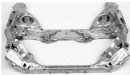
Subchasis delantero, visto de arriba
