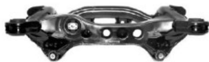
Subchasis trasero, visto de abajo
