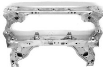
Subchasis delantero, visto de abajo
