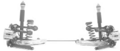
Suspensión delantera completa desmontada
